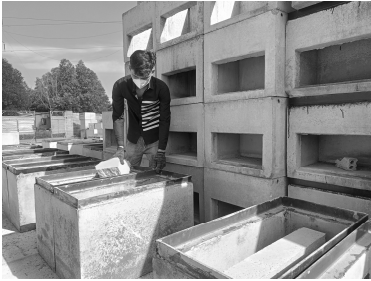
Công nhân Công ty Sigen vệ sinh lô hàng hồ ga của hệ thống thoát nước thải mới ra lò của công ty.
